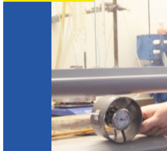
Abzugsprüfung mit Flügelrad-Anemometer
