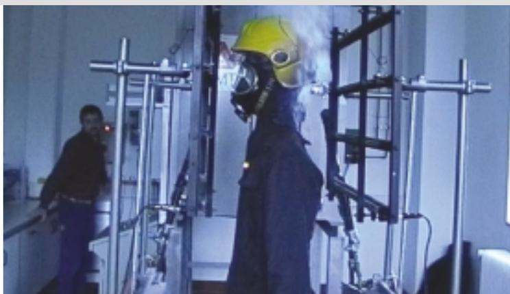
bereits nach fünf Minuten Temperaturen von 55 °C im Kopfbereich des Trägers gemessen. Dies bedeutet, dass dieser Feuerwehrschtzhelm keinen ausreichenden Hitzeschutz bietet, wenn mit Aufhalten über mehr als fünf Minuten in Bereichen gerechnet werden muss, in denen die Umgebungstemperatur 200 °C und mehr beträgt.
