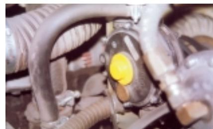
Abb. 3: Verdampfer mit farbiger Abdeckkappe in eingebautem Zustand (Abblaseleitung an Atemöffnung fehlt)
