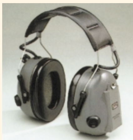
Der hörende Gehörschutz: Der elektro-akustische Gehörschutz ist in der Lage, schwache Geräusche zu verstärken und laute Geräusche zu dämmen. Durch ein elek- tronisches Ventil wird ein starkes Impuls- geräusch in weniger als 2 Millisekunden auf ein ungefährliches Maß gedämmt.
