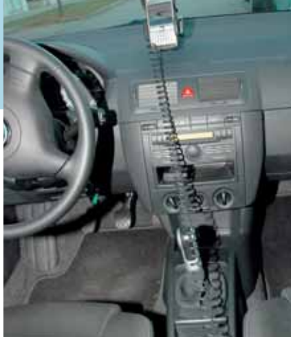
Eingeschränkte Fahrzeugbedienung durch ungünstig verlegtes Kabel
