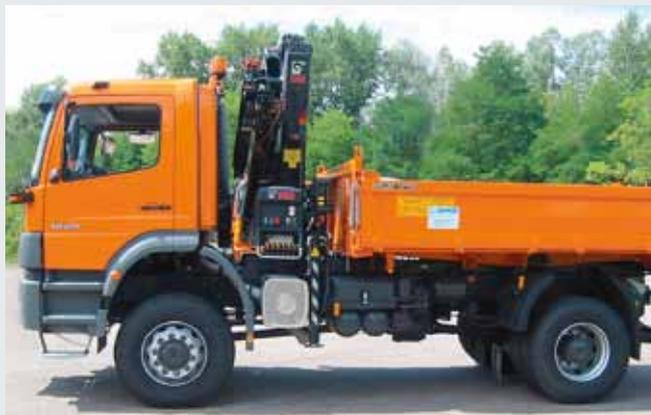
müssen mit einem Nothalt nachgerüstet werden, um die Quetschgefahr für den Kranführer durch den Ausleger zu minimieren.
