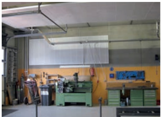
Bild 2: Schlosserei nach Lärminderungsmaßnahmen
