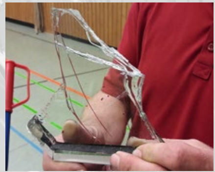
Abb. 2: Unfallsituation – Bruchbild der nicht sicheren Verglasung.
