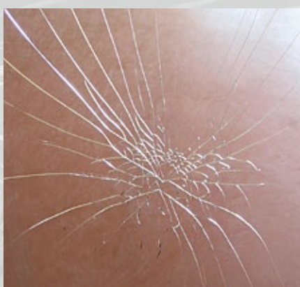
Abb. 7: VSG-Bruchbild – es ist splitterbindend und durchbruchhemmend.
