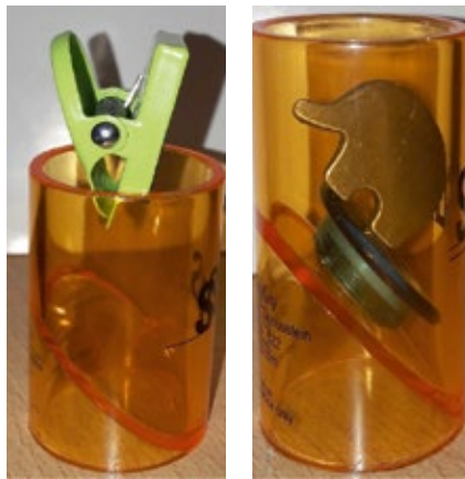
Abb. 4: Der „Verschluckzylinder-Test“ zeigt Magnete, die als sicher (links) und unsicher (rechts) eingestuft werden können: Passen die Magnete wie hier in den Prüfzylinder, besteht eine erhöhte Verschluckungsgefahr. Diese Magnete sind für Kleinkinder tabu. Auch größere Kinder sollten nicht damit spielen.
