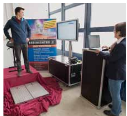
Die Sprungwaage misst die Körperbelastung z. B. beim Sprung aus dem LKW-Fahrerhaus.
