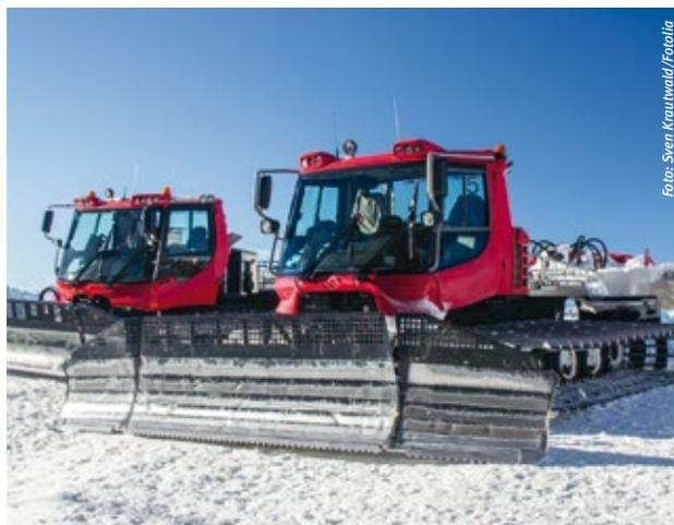
Ohne vorherige Betätigung der Feststellbremse und Einlegen der Neutralstellung am Fahrtrichtungsschalter verließ er das lediglich verlangsamt Fahrzeug, um mit einem Skilangläufer zu sprechen. Das Hosenbein des Fahrers verfang sich dabei in der Kette der noch langsam fahrenden Maschine, sodass der Mann unter das Fahrzeug gezogen und überfahren wurde. Die vorbildlich sofort eingeleiteten Wiederbelebungsversuche des Skifahrers und weiterer Passanten blieben ohne Erfolg.
