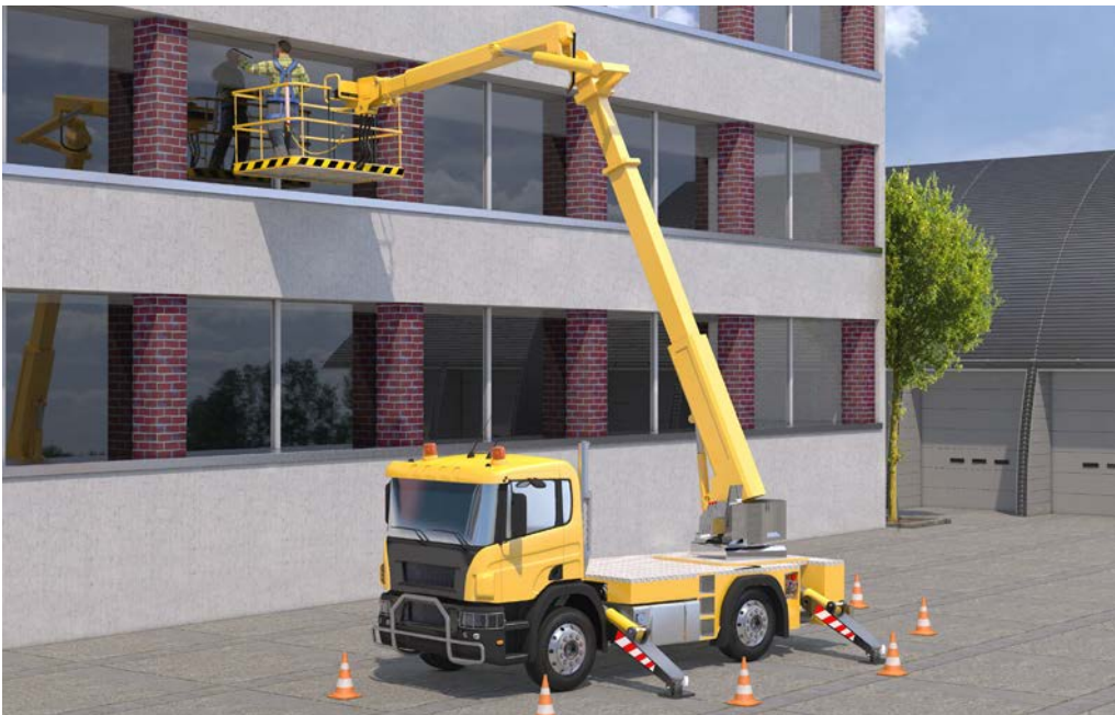
Abb. 41 Teleskopbühne im Einsatz
