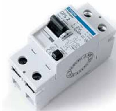
Der Fehlerstromschutzschalter registriert, wenn der hin- und zurückfließende Strom nicht gleich stark ist, weil der Strom z. B. durch den Körper eines Menschen fließt, und schaltet den Stromkreis sofort ab. Das kann lebensrettend sein, denn das Ausmaß der Schädigung durch den Strom hängt u. a. auch von seiner Einwirkdauer ab.
