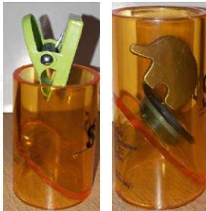
Abb. 4: Der „Verschluckzylinder-Test“ zeigt Magnete, die als sicher (links) und unsicher (rechts) eingestuft werden können: Passen die Magnete wie hier in den Prüfzylinder, besteht eine erhöhte Verschluckungsgefahr. Diese Magnete sind für Kleinkinder tabu. Auch größere Kinder sollten nicht damit spielen.
