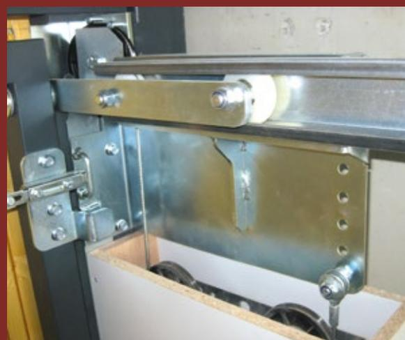
**Sehr gut!** Die Laufschiene ist sehr stabil und hat eine gute seitliche Führung der Laufrollen. Die Laufrollen sind mit Sicherheitsmuttern sicher und dauerhaft befestigt.
