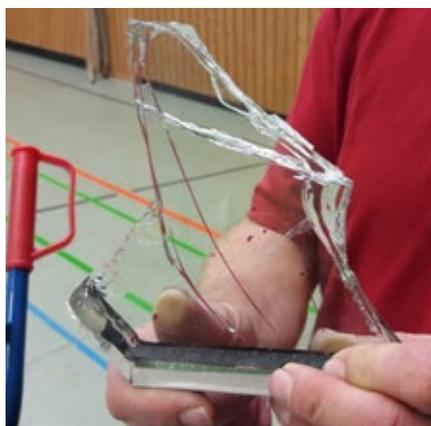
Abb. 1 – Unfallsituation: Bruchbild der nicht sicheren Verglasung. Der Schüler wäre fast verblutet!
