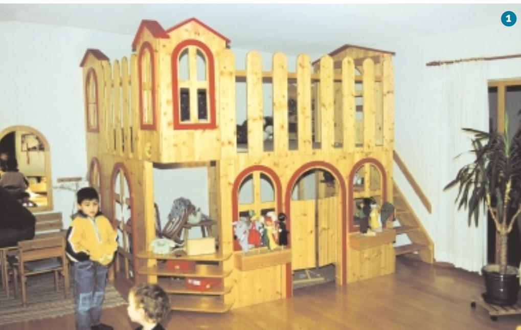
Fenster mit „Leitereffekt“ sind zu verkleiden – z. B. mit lichtdurchlässigem, bruchsicherem „Kunststoffglas“
