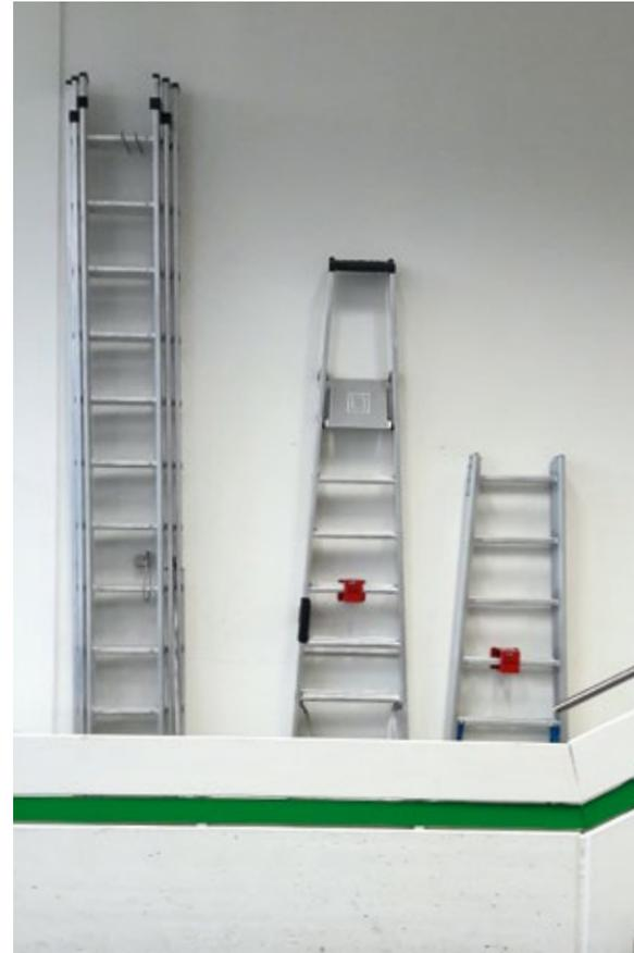
Abb. 4 – Vorbildliches „Leiter-Management“: Hier ist jederzeit die richtige und für die Arbeitsaufgabe geeignete Leiter schnell verfügbar. Die beiden rechten Leitern (Stehleitern) sind für die Nutzung als Anlegeleitern nicht zulässig! Alle Leitern sind gegen Diebstahl/unbefugte Benutzung gesichert.
