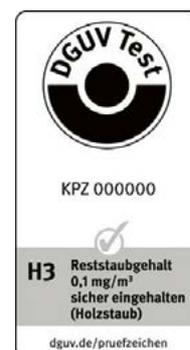
Geräte mit Prüfzeichen „H3“ für den Anschluss an stationäre Holzbearbeitungsmaschinen halten die geltenden Anforderungen an Entstauber für Lufrückführung in den Arbeitsraum ein
