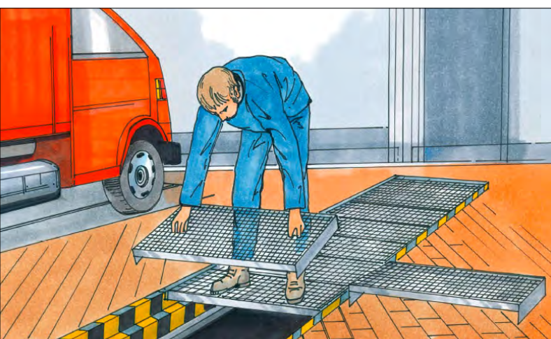
Darstellung des Abdeckens einer Arbeitsgrube mit freier Lüftung durch Gitterroste und deutlicher Gefahrenkennzeichnung am Rand. (Bild: BG RCI)
